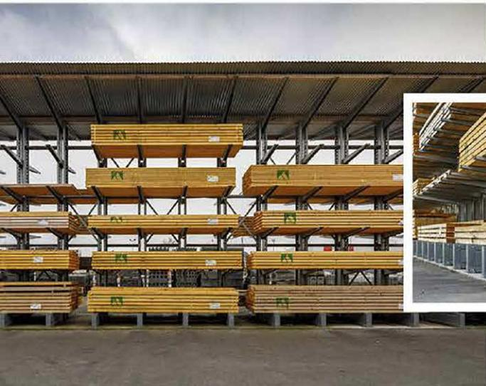
Conformes aux nouvelles réglementations (FEM 10.2.09 - mars 2017), nos cantilevers sont conçus pour le stockage de charges longues telles que le bois, métaux, etc.
